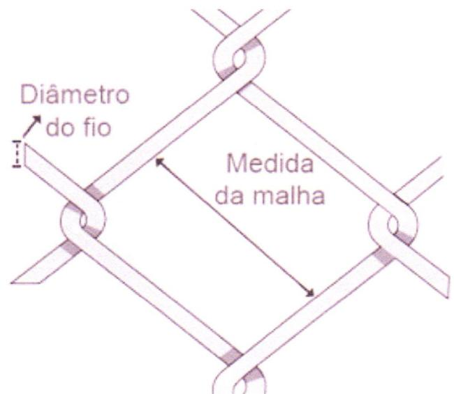
Tela de arame galvanizado malha 3" x 3", que representa um espaçamento de 76,20mm na indicação de "medida da malha".
